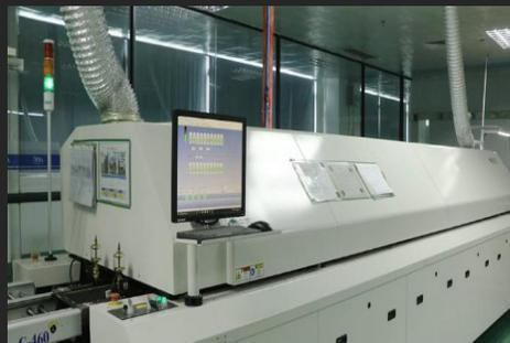
无铅回流焊锡炉
